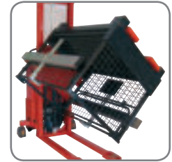
Der Behälter lässt sich zur vollständigen Entleerung drehen, wenn der Rotator Boxhalter mit Klemmvorrichtung hat.
