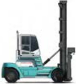
Einzelstapeln 3–6 hoch bis zu 8 Tonnen
