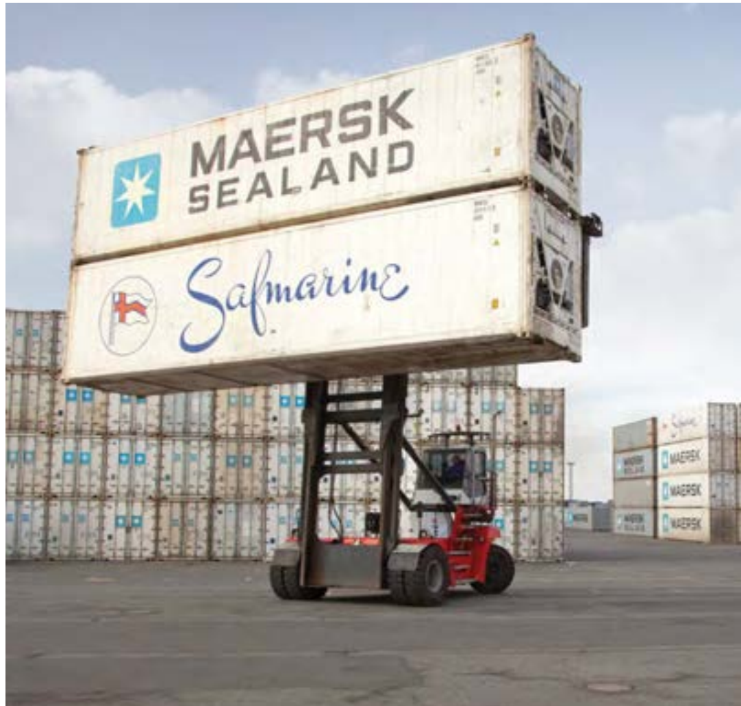
Der SMV 5/6 ECB 100 DS transportiert 2 Container gleichzeitig – schnell, sparsam und leise.
